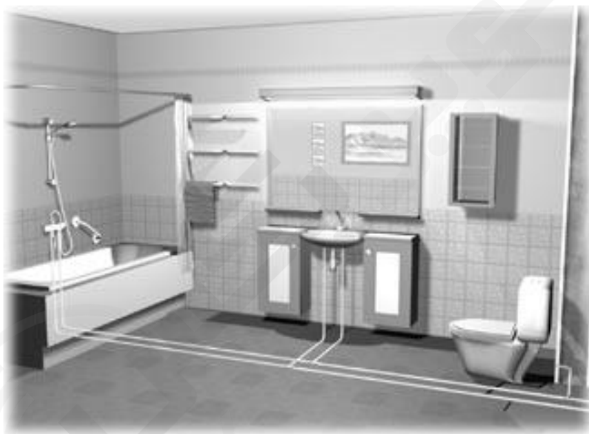
تصویر ۷. روش کلاسیک سیستم لوله‌کشی سوپرپکس
